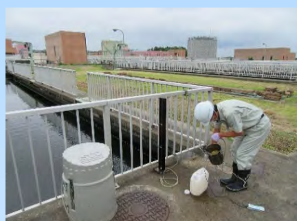
水質検査(処理水採水)
